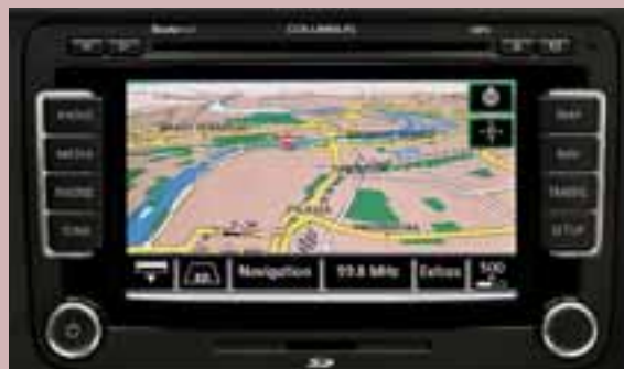
Sistema di navigazione Columbus: oltre alle funzioni del sistema di navigazione Amundsen, offre un display touch-screen a colori ad alta definizione da 6.5", DVD di navigazione in due versioni (per Europa Occidentale ed Europa Orientale), hard disk da 30GB con copiatura opzionale di dati di navigazione su hard disk e calcolo rapido dell'itinerario e relativa proiezione grazie ad un processore ad alte capacità ed altre funzioni.
