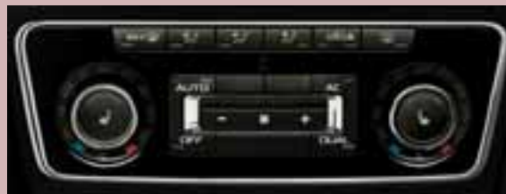
Climatronic: climatizzatore bizona a regolazione elettronica, inclusa regolazione automatica del ricircolo interno. Impostazione e mantenimento automatico della temperatura dell'aria interna, così come dell'intensità e della direzione del flusso d'aria.
