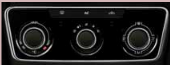
Climatic – climatizzatore con regolazione automatica: impostazione e mantenimento automatico della temperatura interna, impostazione manuale di intensità e direzione del flusso d'aria.
