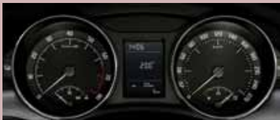
Quadro strumenti con un indicatore multifunzione.
