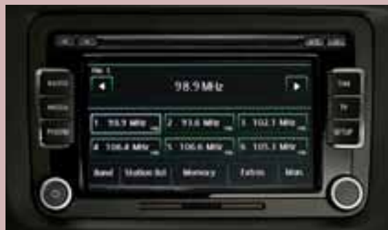
Radio Bolero: oltre alle funzioni della radio Swing dispone di funzione Memory per informazioni radio sul traffico (TIM), un caricatore di 6 CD integrato, display touch-screen a colori da 6.5" (TFT), lettore per schede dati SD o MMC con file di formato MP3 o WMA, compatibile con il Sound-System.
