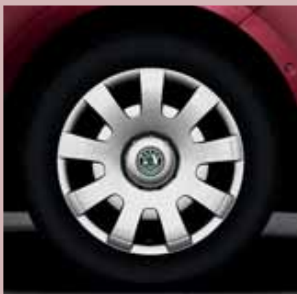
Cerchi in acciaio 16" 7.0J, abbinati a pneumatici 205/55 R16 con coprimozzo TEMPEL .
